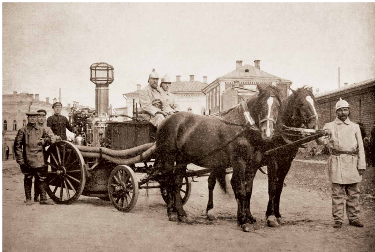
Конный ход пожарного обоза 1-й части Симбирска с паровой машиной
